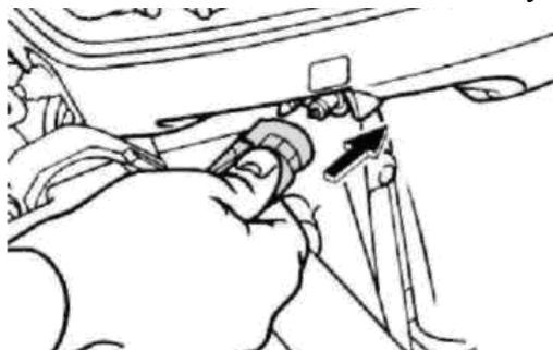
Обеспечьте жесткое крепление линии подачи топлива к этому соединителю. После этого также жестко присоедините другой конец линии подачи топлива к соединителю топливного бака.
