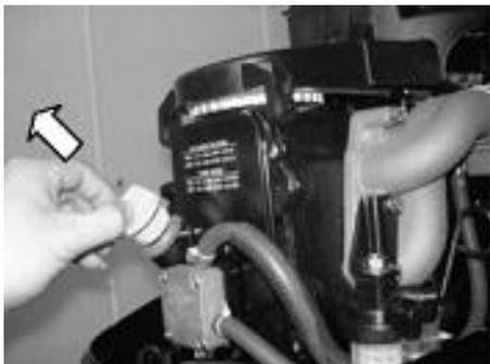
4. Наденьте новую прокладку на сливной винт и закрутите его.
