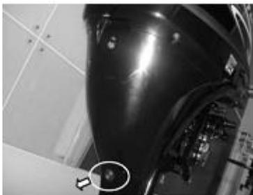
3. снимите крышку масляного отверстия и дайте маслу полностью вытечь из сливного отверстия
